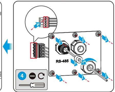
CT Communication Cable | Комуникационен кабел CT | Komunikační kabel CT | CT-kommunikationskabel
