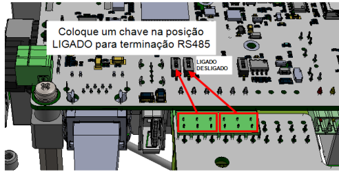
Figura 17: chave de terminação RS485 no inversor
