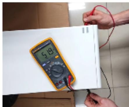
Un módulo en el que una de las 32 (HVS) / 16 (HVM) celdas tiene un voltaje de <1.5V está en subtensión (consulte con BCP (sección 2.6) / BC si es posible).
