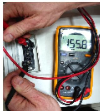
Si el voltaje medido se desvía significativamente del valor nominal, verifique el voltaje eléctrico en los módulos individuales, como se muestra a continuación:
